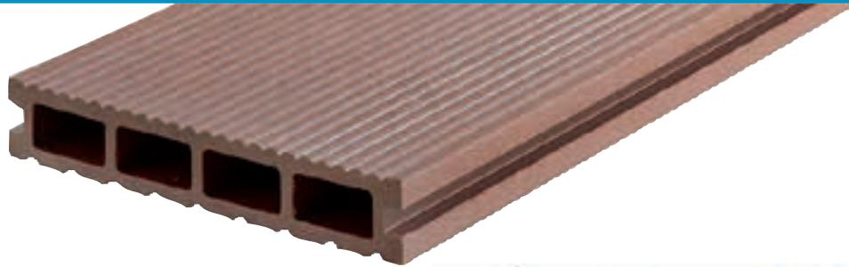
Green Plank® ist ein Holzverbundwerkstoff aus 70 % Holzfasern und 30 % Polyethylen (HDPE) mit einer sehr hohen Oberflächenhärte. In einem Extrusionsverfahren werden Fichtenfasern mit HDPE ummantelt und zu einem Hohlkammerprofil verarbeitet. Man erhält so ein Material von hoher Dichte und sehr langer Haltbarkeit, vergleichbar mit Harthölzern.
