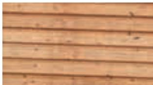
**PINHOLES:** Hierbei handelt es sich um Fraßgänge kleiner Insekten, die keinerlei Einfluss auf die Dauerhaftigkeit oder Statik des Holzes haben. Die Insekten sind nicht mehr aktiv. Der Durchmesser der Pinholes beträgt ca. 1 bis 1,5 mm. Pinholes kommen nur bei Bangkirai und vereinzelt bei Massaranduba vor.
