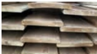
**QUELLEN UND SCHWINDEN:** Durch klimatische Einflüsse nimmt das Holz Feuchtigkeit auf und gibt es ab. Bei der Aufnahme kommt es zum Quellen des Holzes, bei der Abgabe zum Schwinden. Je nach Holzart fällt dieser Vorgang unterschiedlich aus. Bei Kiefer KDI z.B. kann es in der Stärke und Breite Veränderungen bis zu 8% geben. Berücksichtigen Sie diesen Umstand bei Ihrer Planung und Konstruktion.
