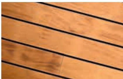
**STÖCKERMARKIERUNGEN UND HOLZVERFÄRBUNGEN:** Durch den Prozess der Acetylierung kann es bei accoya® zu Holzverfärbungen kommen in denen sich die Stöckermarkierungen abzeichnen. Bei diesen Verfärbungen handelt es sich um ausgetriebene Holzinhaltstoffe. Sie setzen sich in den oberen ca. 5 mm des Holzes ab und werden z.B. bei der Sortierung COUNTRY nicht völlig abgehobelt. Bei der Sortierung SELECT treten diese Verfärbungen nur vereinzelt auf.
